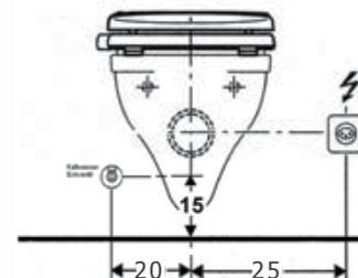
Vorbereitung für den Strom und Wasseranschluss bei Neuinstallation unterputz.
